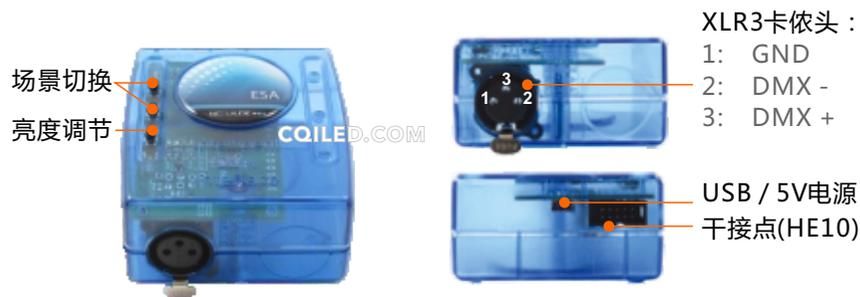
使用PCB上的接口, 方便您对控制器外形进行定制。
