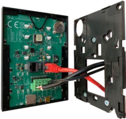
螺丝端子：电源输入，DMX1输出 红色网线：连接路由器
